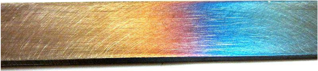
Figuur 3-14. Verkleuringen door tempering
